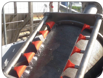
Siebtrommel mit Reinigungsdüsen
